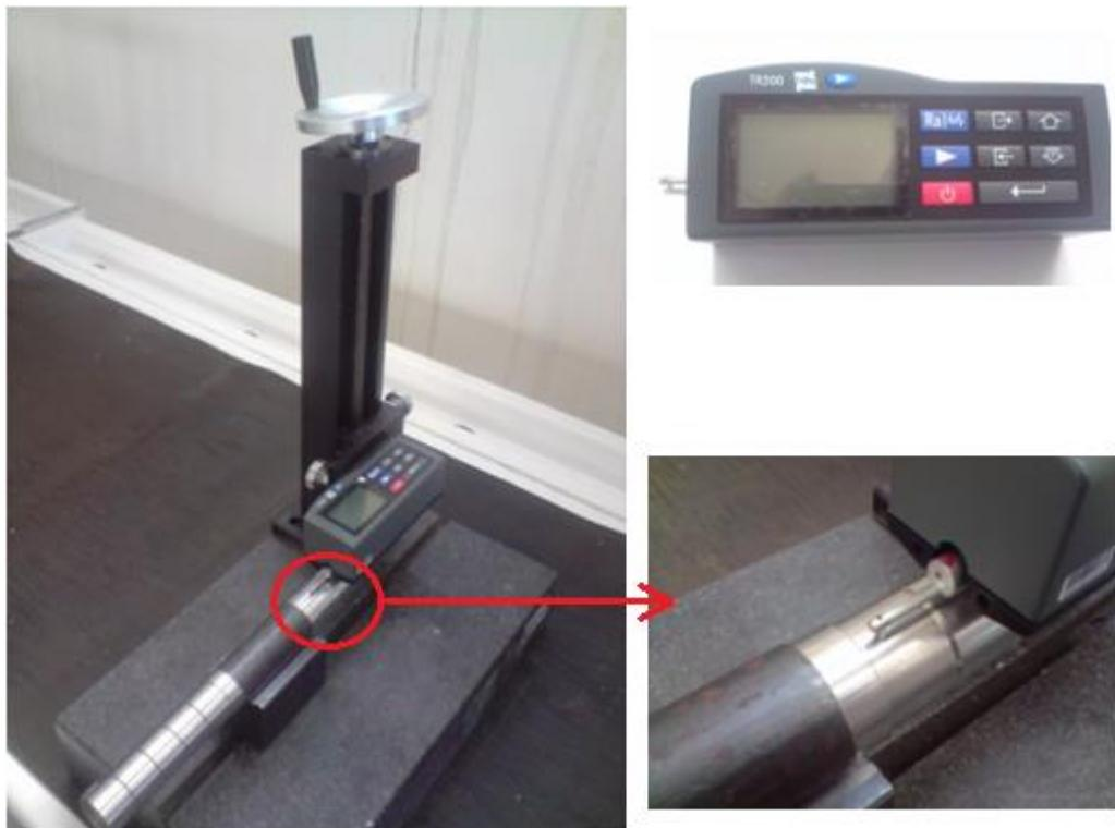
الشكل (6-2) جهاز قياس الخشونة
